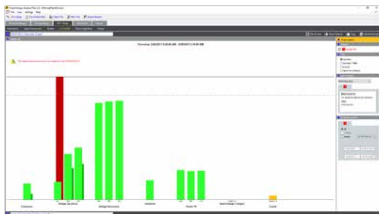
Fluke Energy Analyze Plus : résumé de l'état de la qualité du réseau électrique
