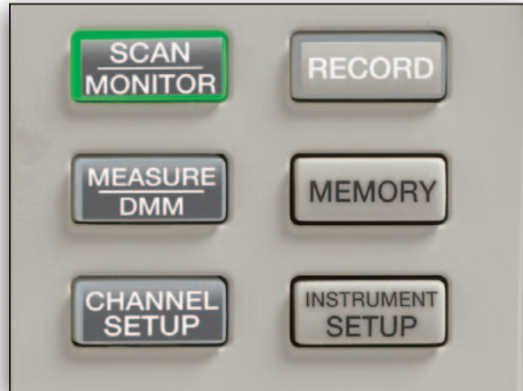
Touches de fonction de balayage, de surveillance, de mesure et DMM sur le panneau avant.
