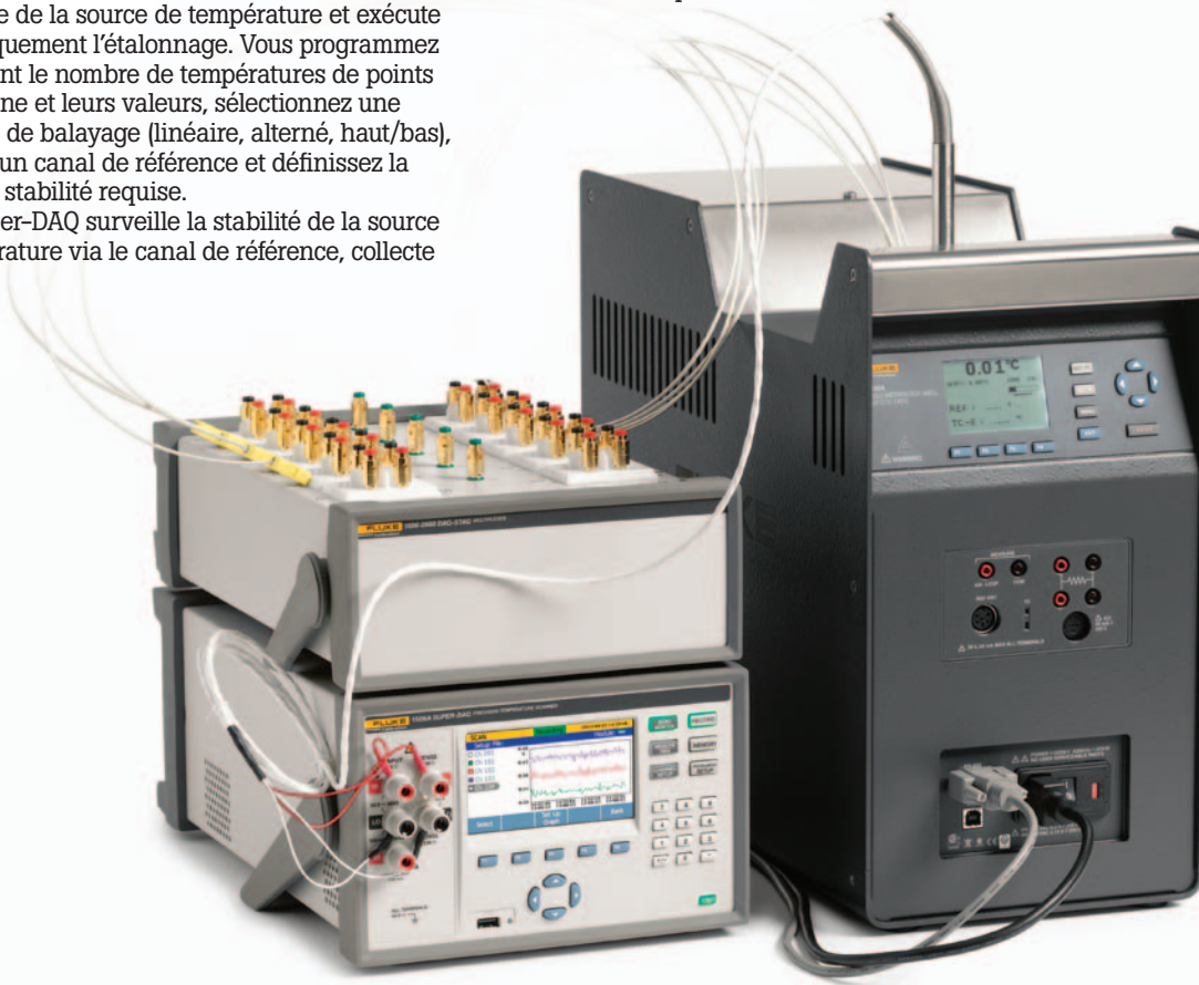
1586A configuré avec un DAQ-STAQ et un puits de métrologie de terrain 9190A pour un étalonnage automatisé de capteur.
