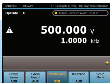
Produktfunktionen wie Verstärkung und Breitband werden ganz einfach über die Symbolleiste am unteren Rand des Ausgabebildschirms aktiviert. Diese Symbolleiste enthält fünf Tasten.
