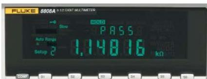
Über die Setup-Tasten (S1 - S6) ist die schnelle Durchführung wiederholter Messungen möglich. Diese gespeicherten Einstellungen können auch den Grenzwertvergleichsmodus mit Gut/Schlecht-Indikatoren enthalten.
