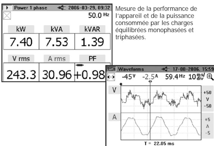
Mesure de la performance de l'appareil et de la puissance consommée par les charges équilibrées monophasées et triphasées.
